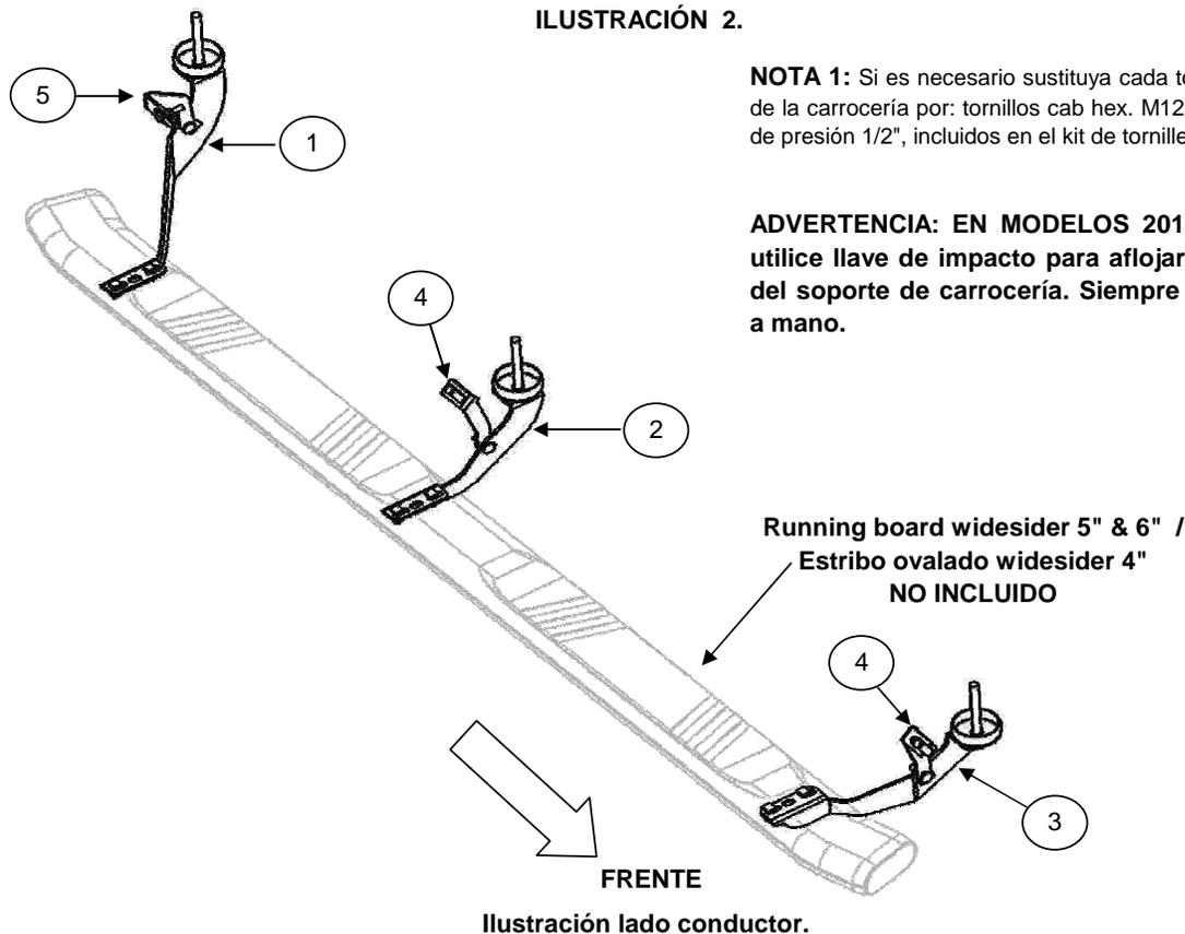
**NOTA 1:** Si es necesario sustituya cada tornillo que sujeta el soporte de la carrocería por: tornillos cab hex. M12 x 120mm, rondana plana y de presión 1/2", incluidos en el kit de tornillería.
