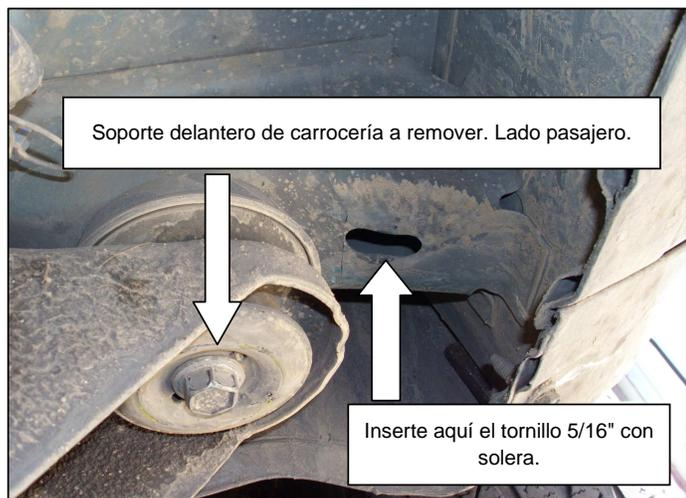
3. Instale el bracket delantero y fije con la tornillería antes removida. Localice el orificio que se encuentra en la carrocería del vehículo e inserte un tornillo 5/16" con solera. Monte el bracket auxiliar delantero y fije con: rondana plana y de presión 5/16", tuerca hex. 5/16". En el otro extremo del bracket fije al bracket delantero con: tornillo cab. coche 3/8 x 1", rondana plana y de presión 3/8", tuerca hex. 3/8". **VER FOTO 1, ILUSTRACIÓN 3.** No apriete aun.
