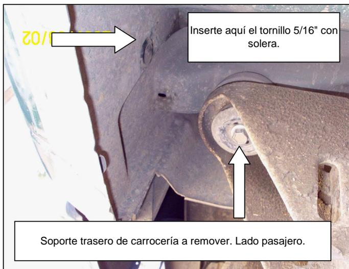
7. Instale el bracket trasero y fije con la tornillería antes removida. Localice el tapón de plástico que se encuentra en la carrocería del vehículo, remuévalo e inserte un tornillo 5/16" con solera. Monte el bracket auxiliar trasero y fije con: rondana plana y de presión 5/16", tuerca hex. 5/16". En el otro extremo del bracket fije al bracket trasero con: tornillo cab. coche 3/8 x 1", rondana plana y de presión 3/8", tuerca hex. 3/8". **VER FOTO 3, ILUSTRACIÓN 5.** No apriete aun.
