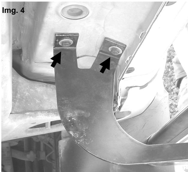
4. Para instalar el bracket central y también el trasero, utilice dos tornillos M8x25 cabeza hexagonal galvanizados, dos rondanas planas y dos rondanas de presión para cada brackets. Vea la **imagen 5** y repita la operación del lado contrario del vehículo
