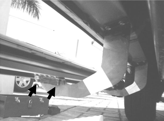
8. Para instalar el Estribo ovalado de 4", por cada bracket, utilice dos tornillos cabeza cuadrada, dos rondanas planas y dos rondanas de presión, todos de color negro. **Vea la imagen 9 y repita la operación del lado contrario del**
