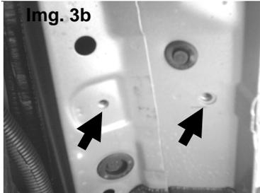
3. Para instalar el **bracket delantero**, utilice dos tornillos M8x25 cabeza hexagonal galvanizados, dos rondanas planas y dos rondanas de presión. Vea la **imagen 4** y repita la operación del lado contrario del vehículo.
