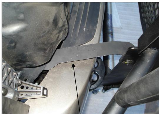
Bracket auxiliar instalado, lado pasajero.
