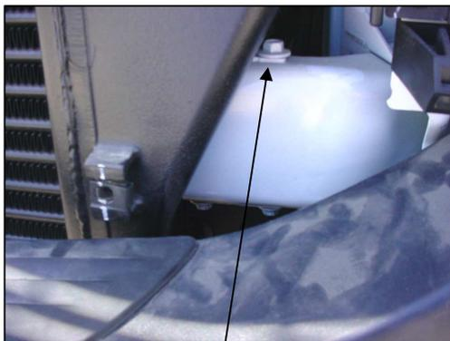
Tornillo a remover para la instalación del bracket auxiliar, lado conductor.
