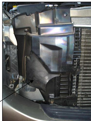
5. Instale los brackets auxiliares y fije con los tornillos removidos, en lado conductor y pasajero. No apriete aun.
