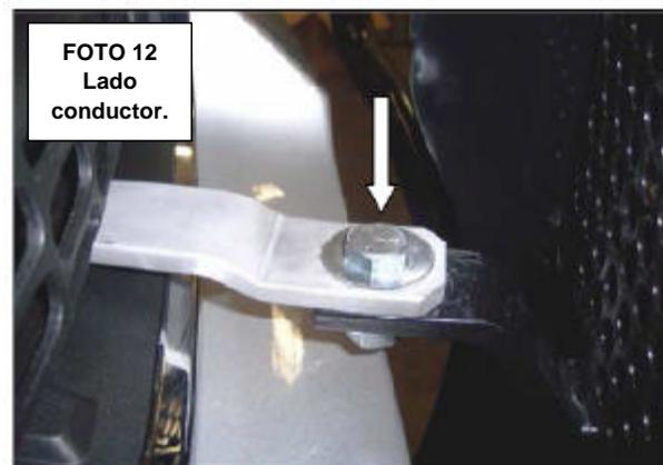
9. Realice cualquier ajuste a la alineación del Wrangler con el vehículo y apriete toda la tornillería empezando por los bracket al vehículo y después el Wrangler a los brackets.
