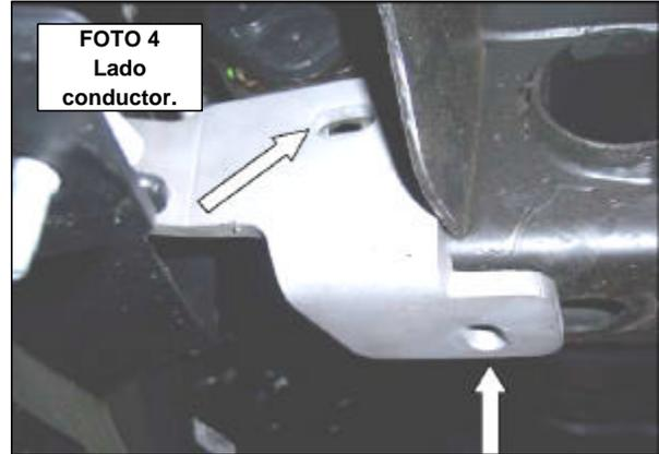
5. Coloque el gancho de arrastre dentro del chasis, alinee el gancho de arrastre y bracket inferior con los barrenos del chasis y fije con la tornillería antes removida. No apriete aun. **Ver fotos 5 y 6.**
