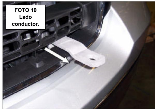
8. Monte el Wrangler a los brackets inferiores y fije usando tornillos cab. hex. 1/2 x 2", rondanas planas 1/2", rondanas de presión 1/2" y tuercas hex. 1/2", fije a los brackets superiores usando tornillos cab. hex. 1/2 x 1 1/2", rondanas planas 1/2", rondanas de presión 1/2" y tuercas hex. 1/2". Realice los ajustes necesarios para alinear el Wrangler con el vehículo y fije toda la tornillería. **Ver fotos 11 y 12.**
