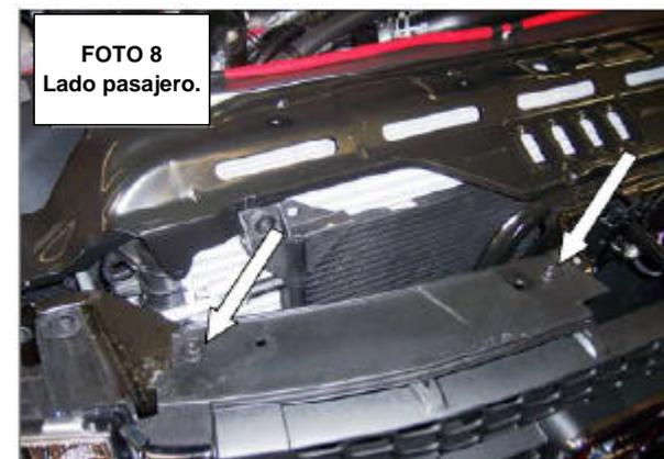
7. Remueva el tornillo superior que sujeta la defensa del vehículo en el lado conductor. Coloque el bracket superior, lado conductor, y fije con el tornillo antes removido. **Ver fotos 9 y 10.**
