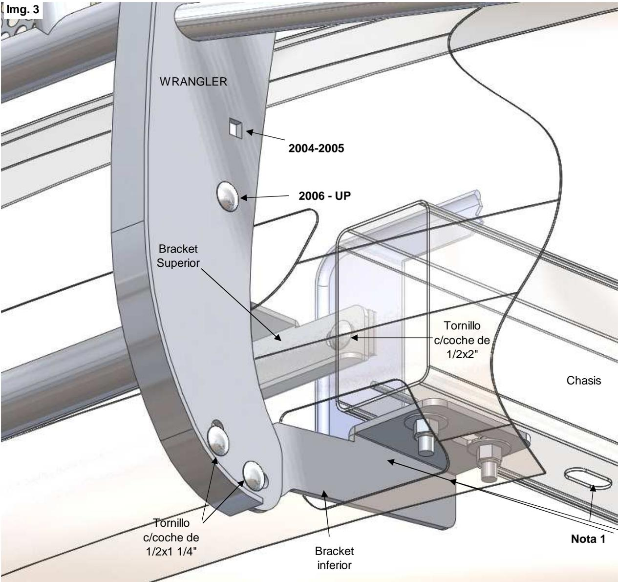
El diagrama explica como instalar el bracket inferior en vehículos sin ganchos, si el vehículo tiene ganchos de arrastre, se utilizaran los tornillos del vehículo quedando instalados los ganchos.
