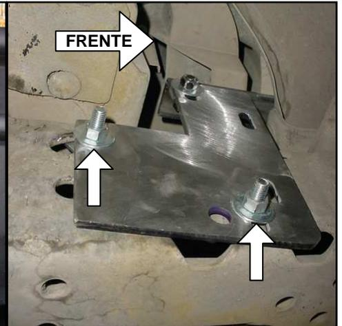
Bracket auxiliar instalado. Foto lado pasajero, parte interior.
