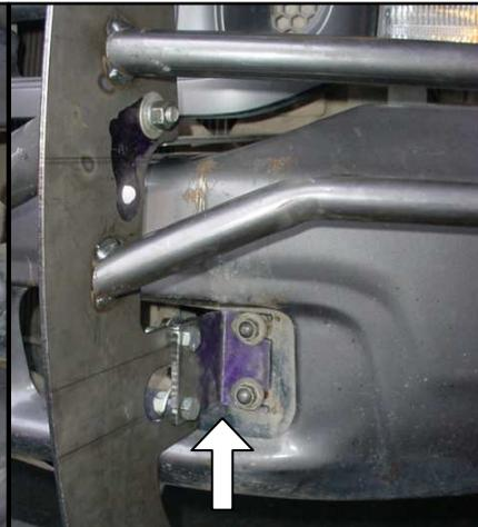
Bracket principal instalado. Foto lado conductor.
