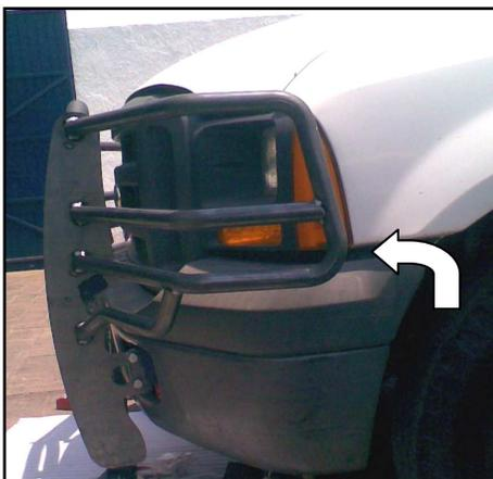
Inserte por aquí el complemento bracket auxiliar, y recórralo hasta llegar al bracket auxiliar y fije con la tornillería antes mencionada. Foto lado conductor.
