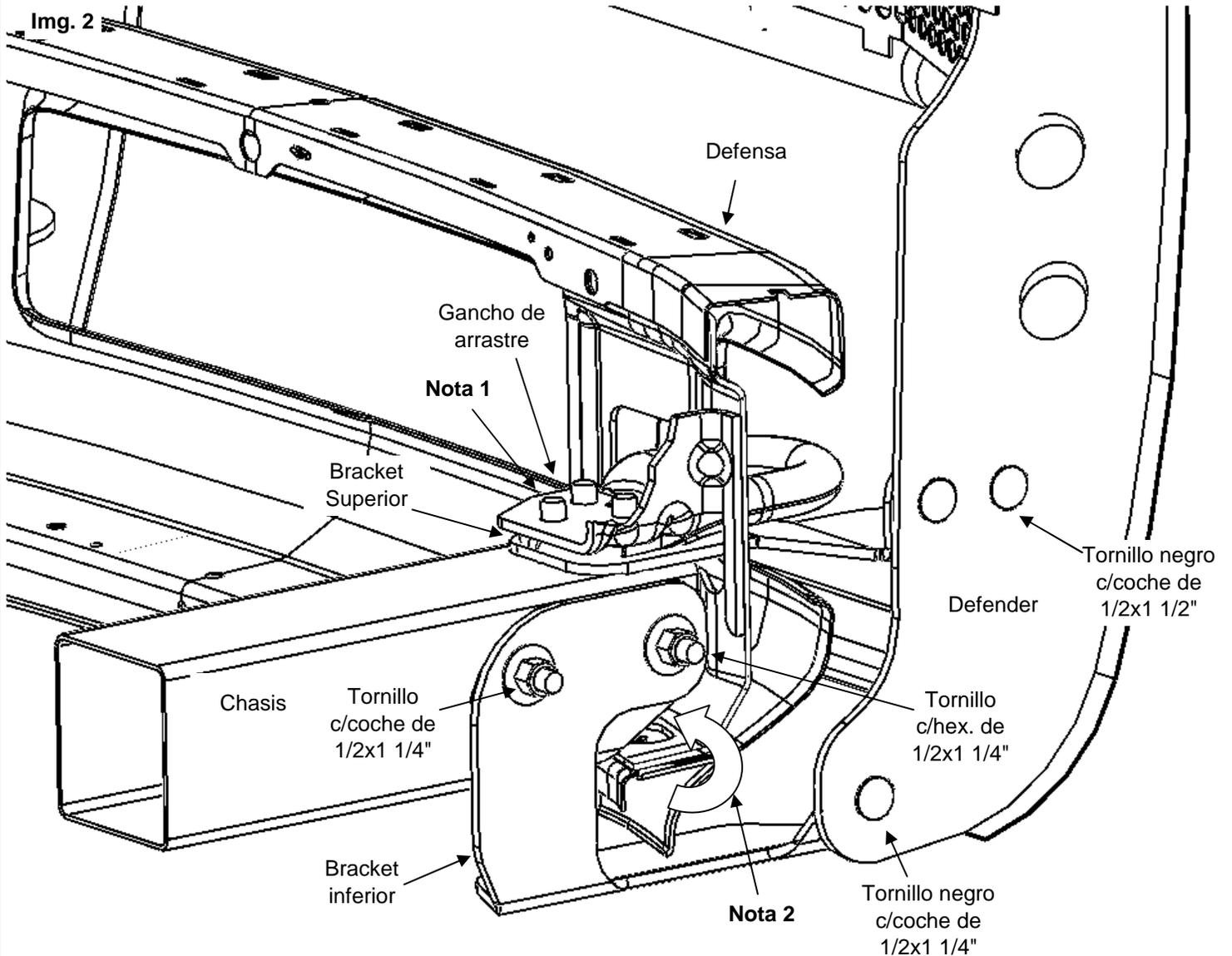
**Nota 1.** Para quitar e instalar los tornillos del gancho de arrastre, puede utilizar un nudo para dados, el acceso a ellos es por la parte inferior del chasis.
