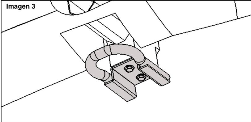
8- Instale el bracket inferior, en este utilizara los tornillos removidos del gancho de arrastre, repita la operación del lado contrario del vehículo.
