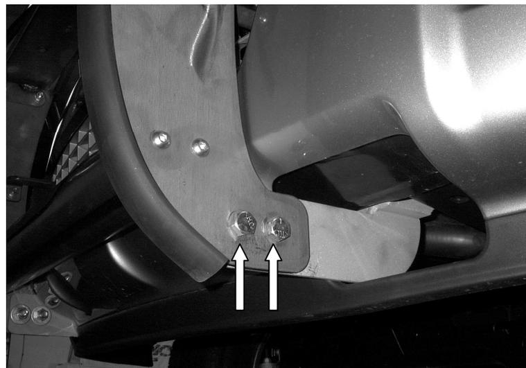
**STEP 7. ATTACH THE GRILLE GUARD ASSEMBLY TO THE UPPER BRACKETS USING THE 3/8" FASTENERS.**
