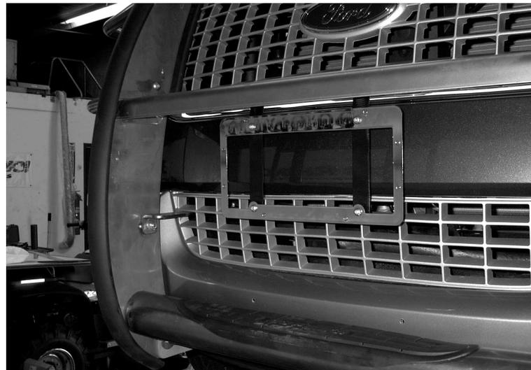
**STEP 10. RE-ATTACH THE RUBBER SPLASH GUARD USING THE PLASTIC RIVETS SUPPLIED.**
