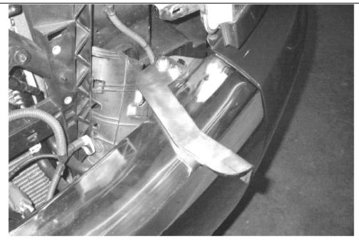
**STEP 6.** POSITION 13681D UPPER BRACKET AS SHOWN. ATTACH THE BRACKET TO THE BUMPER USING THE 8MM HEX BOLTS AND WASHERS SUPPLIED. REPEAT THE INSTALLATION FOR THE PASSENGER SIDE UPPER MOUNTING BRACKET.
