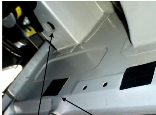
Remover esta cinta protectora, para insertar una solera con tornillo e instalar el bracket trasero. Parte trasera, foto lado conductor.
