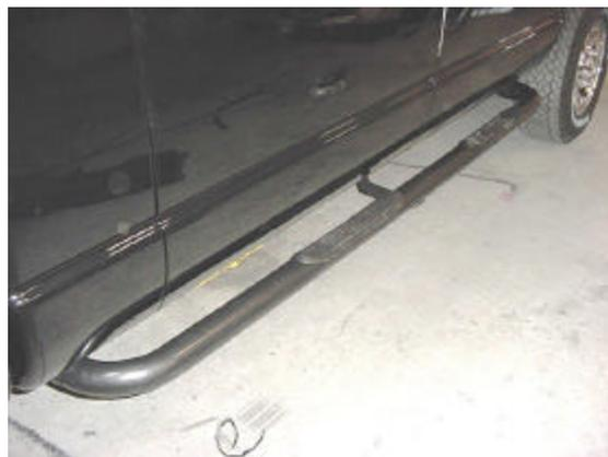
**SIDE BAR INSTALADO. FOTO LADO CONDUCTOR.**
