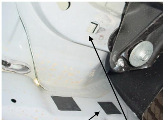
Remover esta cinta protectora, para insertar una solera con tornillo e instalar el bracket delantero. Parte delantera, foto lado conductor.
