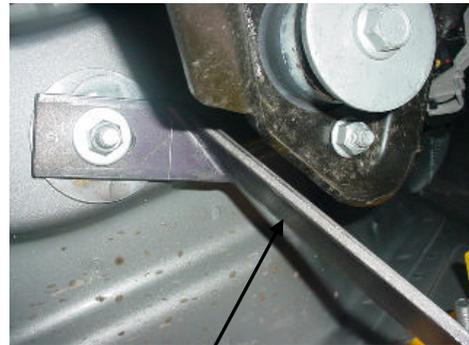
Instale el bracket auxiliar delantero de tal manera que no tenga contacto con el soporte de la carrocería. Foto lado conductor.
