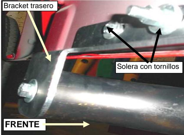
Elija cualquier tornillo de la solera y coloque un empaque de vynil, esto evitara que caiga la solera al interior de la carrocería.
