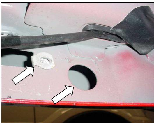
En el orificio, inserte el tornillo 1/2" con solera, y a un lado se muestra la tuerca clip insertada. Foto lado conductor, parte delantera.
