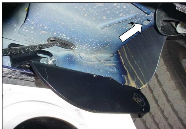
En la parte indicada, inserte el tornillo 5/16" con solera, e instale el bracket auxiliar delantero. Foto lado conductor, parte delantera.
