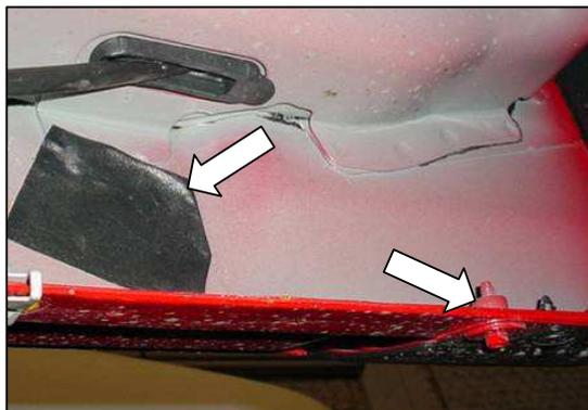
En esta foto se indica la cinta protectora a remover y el tornillo y tuerca clip. Foto lado conductor.
