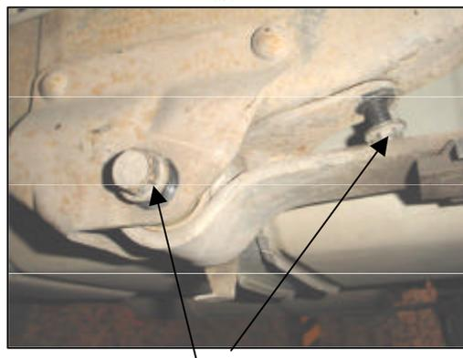
**IMPORTANTE:** Solo afloje estos tornillos para fijación del bracket trasero, lado conductor.
