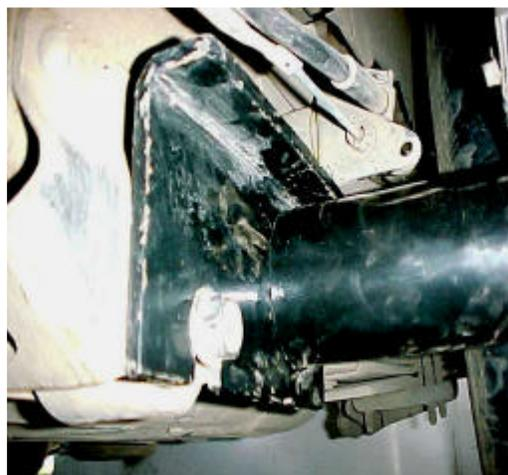
Bracket trasero instalado, lado conductor.
