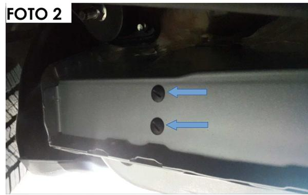
5. Posicione el bracket delantero en los barrenos con rosca y fije con ( 2 ) tornillos M8 x 30mm. ( 2 ) rondana plana 5/16" y ( 2 ) rondana de presión 5/16". **Foto 3.** Posicione el bracket central en los barrenos con rosca y fije con ( 2 ) tornillos M8 x 30mm. ( 2 ) rondana plana 5/16" y ( 2 ) rondana de presión 5/16". **Foto 4.** Posicione el bracket trasero en los barrenos con rosca y fije con ( 2 ) tornillos M8 x 30mm. ( 2 ) rondana plana 5/16" y ( 2 ) rondana de presión 5/16". **Foto 4.**
