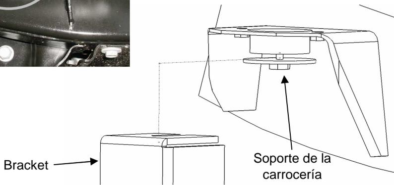
NO INTENTE REMOVER EL TORNILLO COMPLETAMENTE, AFLOJE SOLO LO NECESARIO PARA INSERTAR EL BRACKET.
