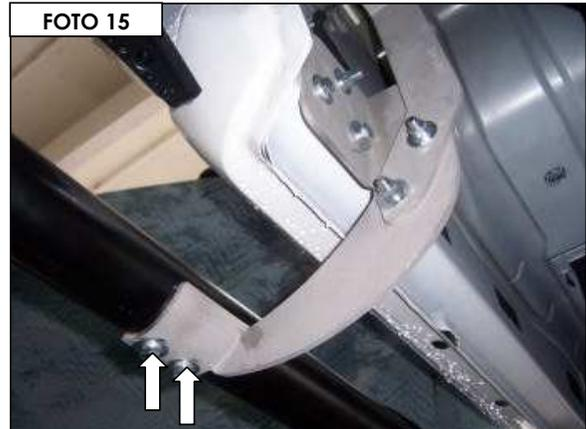
14. Haga cualquier ajuste final a la alineación del estribo y apriete toda la tornillería, comenzando por los brackets.
