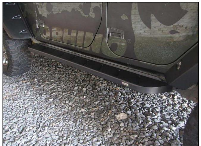
**Step-7** ALIGN THE RB10 SIDE STEP AND THEN TIGHTEN ALL BOLTS.
