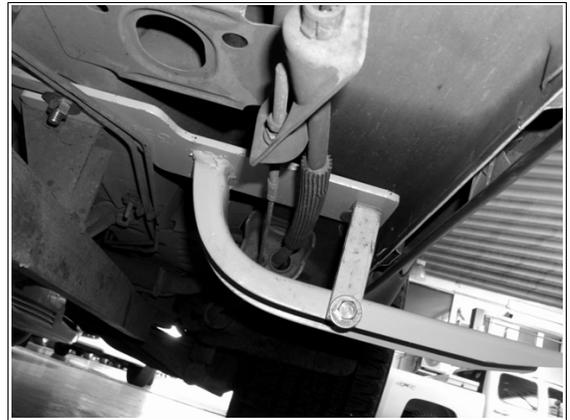
10. Monte el estribo en los brackets e inserte el bracket contra y fije a cada bracket con (2) Tornillos cab. Cuadrada, rondana plana y de presión. No apriete aún.
