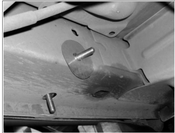
6. Introduzca (1) solera chica con tornillo 3/8" en el orificio de la cara inferior, posicione el bracket delantero y asegúrelo a las soleras con tornillo 3/8" utilizando (1) rondana plana, (1) rondana de presión y (1) tuerca hex 3/8" por cada tornillo. No apriete aún. Foto 4.
