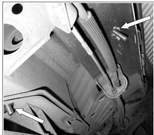
8. Atornille el bracket auxiliar y el bracket trasero a la solera chica c/tornillo, utilizando (1) rondana plana, (1) de presión y (1) tuerca hex 3/8". Foto 7.
