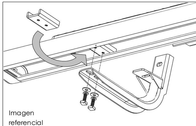
11. Haga los ajustes necesarios para la alineación del estribo, y apriete toda la tornillería comenzando por los brackets al vehículo y después los brackets al estribo.
