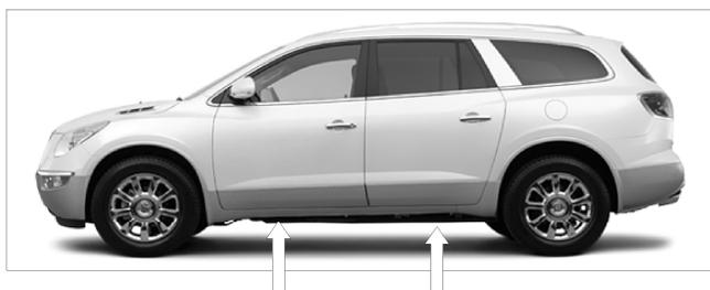
5. Para instalar el bracket delantero, utilice la guía de tornillo 3/8" con (1) tornillo 3/8" c/varilla, introduzca la punta de la guía por el barreno de la cara inferior del rocker panel hasta que salga la rosca del tornillo por el barreno en la pared lateral del mismo, coloque un empaque de vinil en el tornillo. Ver foto 2 y 3. **NOTA:** En algunos casos el canal del rocker panel puede estar relleno con aislante, utilice un desarmador plano para removerlo y permitir el paso del tornillo.
