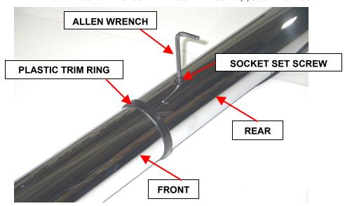
STEP 5. INSTALL THE PLASTIC PLUG TO CONSEAL THE SET SCREW.
