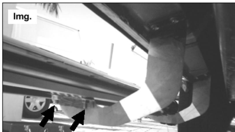
7. Para instalar el estribo ovalado de 4" por cada bracket, utilice dos tornillos cabeza cuadrada, dos rondanas planas y dos rondanas de presión, todos de color negro. **Vea la imagen 9 y repita la operación del lado contrario del vehículo.** No apriete aun.
