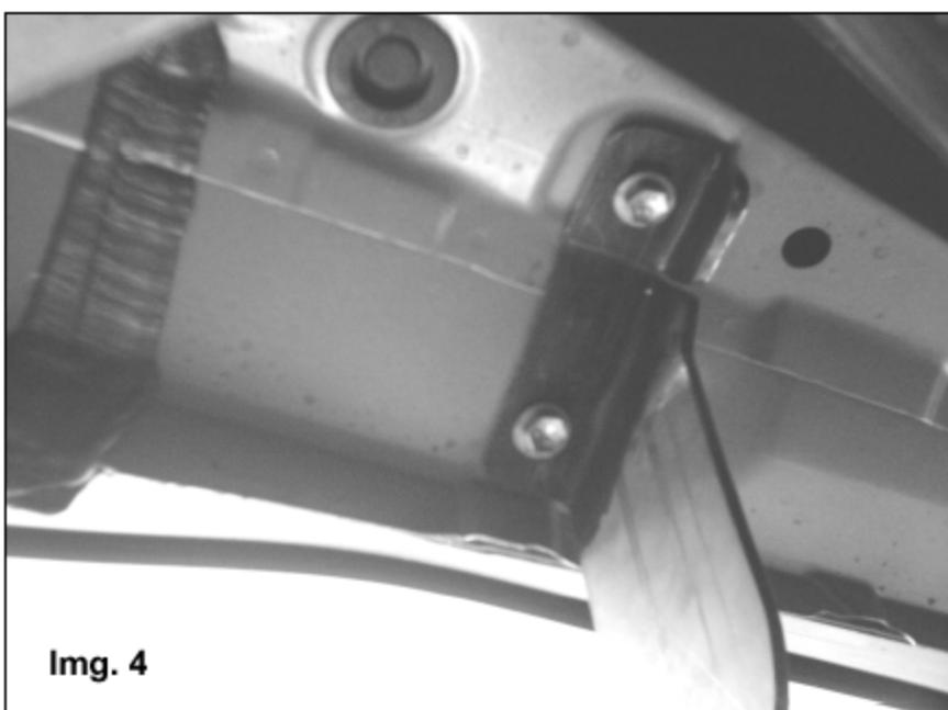
4. Para instalar el bracket central y también el trasero, utilice dos tornillos M8x25 cabeza hexagonal galvanizados, dos rondanas planas y dos rondanas de presión para cada brackets. Vea la **imagen 5** y repita la operación del **lado contrario del vehículo**. No apriete aun.
