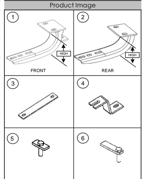
NOTE: THE FRONT BRACKET HEIGHT IS TALLER THAN THE REAR BRACKET.
