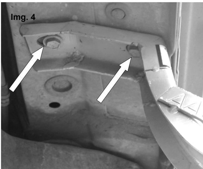
4. Para instalar el bracket central y también el trasero, Utilice dos tornillos M8x25 cabeza hexagonal galvanizados, Dos rondanas planas y dos rondanas de presión para cada bracket. Vea la imagen 5 y repita la operación del lado Contrario del vehículo.
