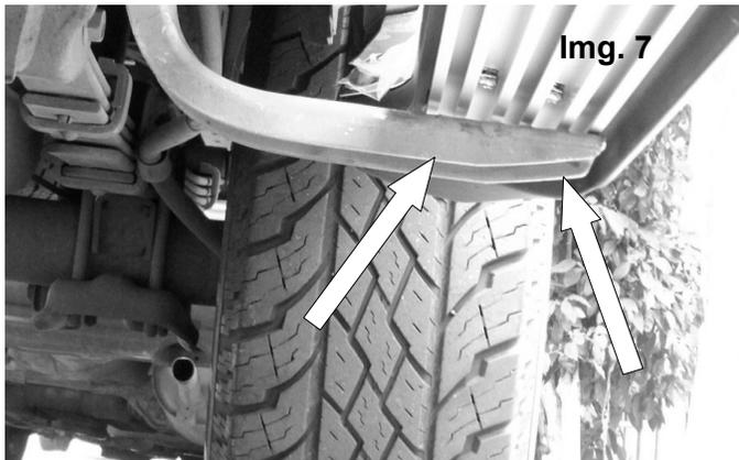
8. para instalar el estribo ovalado de 4", por cada bracket Utilice dos tornillos cabeza cuadrada, dos rondanas planas Y dos rondanas de presión, todos de color negro. Vea la imagen 8. y repita la operación del lado contrario del vehículo.
