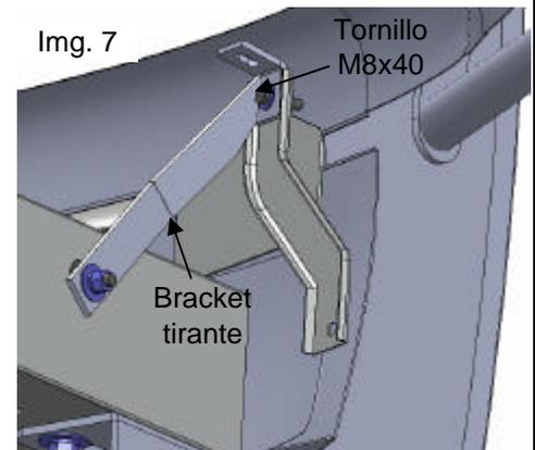
11 . **Inserte por la parte de enfrente de la defensa, el bracket superior y sujételo al bracket tirante**, con el tornillo cabeza coche de 3/8", rondana plana, rondana de presión y tuerca de 3/8". **Img. 8**
