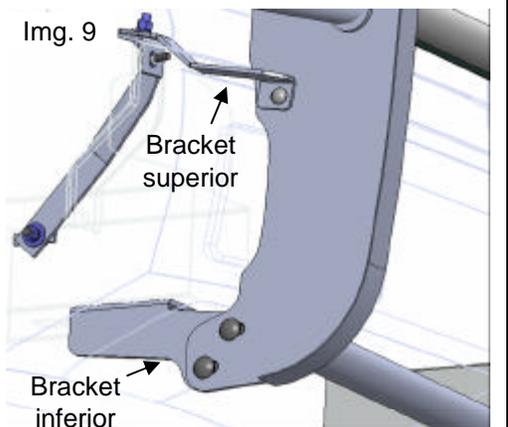
13 . Para la versión en **acabado 1 es necesario instalar los cubre faros**, sin quitar los tornillos, quite las tuercas y rondanas preinstaladas en el cubre faro, ponga el cubre faro en el euroguard como muestra la imagen y sujételo con las rondanas y tuercas removidas
