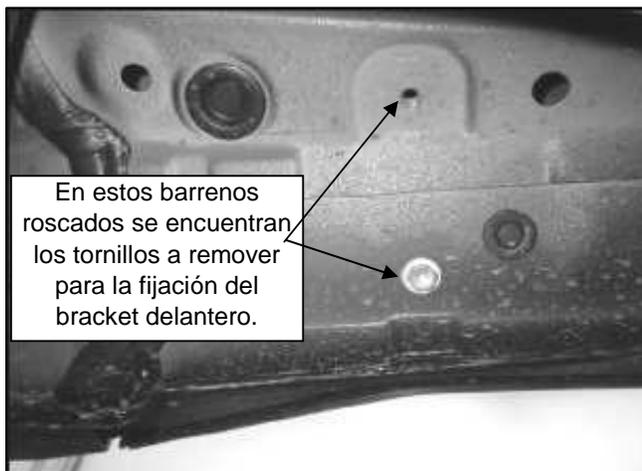
En estos barrenos roscados se encuentran los tornillos a remover para la fijación del bracket delantero.
