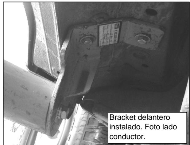
Bracket delantero instalado. Foto lado conductor.
