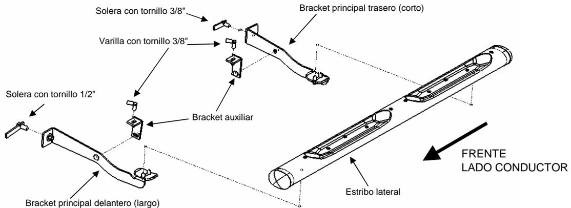
3. Con ayuda de la guía para tornillo inserte la varilla con tornillo de 3/8" dentro del chasis a través del orificio rectangular y saque la punta del tornillo por el barreno que está a un lado. Vea diagrama 1. Fije el bracket auxiliar al chasis usando (1) rondana plana 3/8", (1) rondana de presión 3/8" y (1) tuerca 3/8". No apriete completamente aún.
