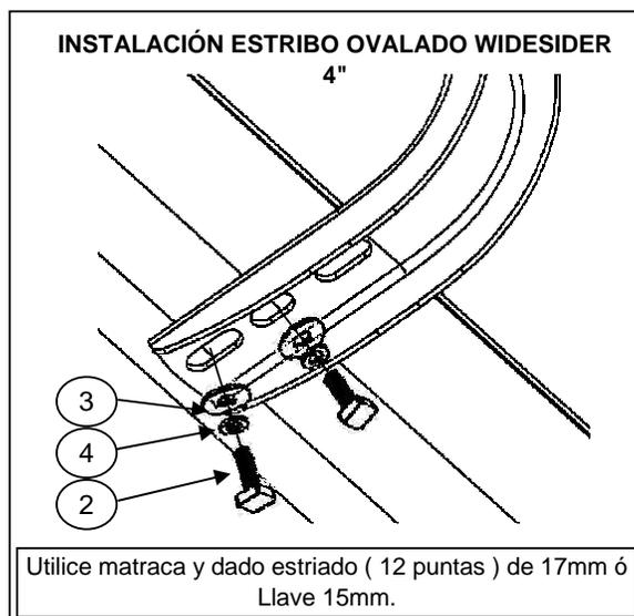
Utilice matraca y dado estriado ( 12 puntas ) de 17mm ó Llave 15mm.
