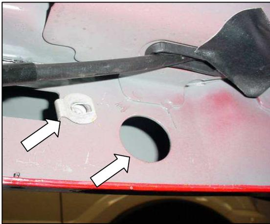
En el orificio, inserte el tornillo 1/2" con solera, y a un lado se muestra la tuerca clip insertada. Foto lado conductor, parte delantera.
