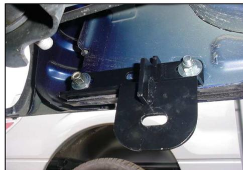
Bracket trasero instalado. Foto lado conductor, parte trasera.
