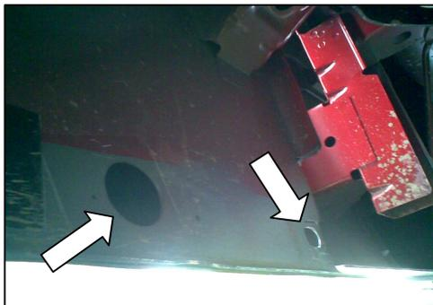
En este orificio, inserte el tornillo 1/2" con solera, y en el otro barreno, fije con el tornillo 1/2 x 2".
