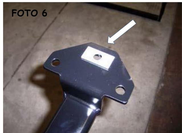
8.- Una el extremo opuesto de la pieza de montaje frontal con el bracket auxiliar utilizando (1pza) 5/16"x 1"
