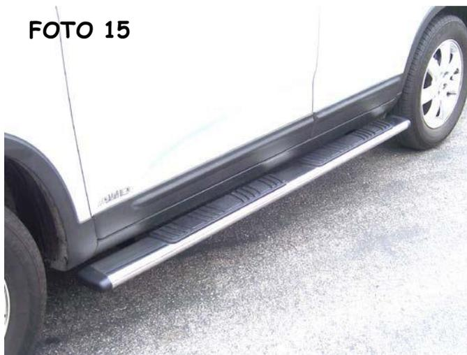
15.-Vuelva a alinear la barra lateral con el vehículo y apriete toda la barra lateral, fijaciones, tuercas y los tornillos de vehículos.
