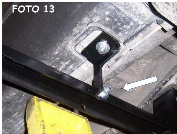
14.- Ajuste el lado del conductor, barra lateral en la parte superior de los brackets y ajustar la barra lateral con el vehículo. Coloque los soportes de sujeción en el interior de la abertura de la barra lateral y alinear las roscas de fijación del soporte con los orificios de ranura en los soportes.
