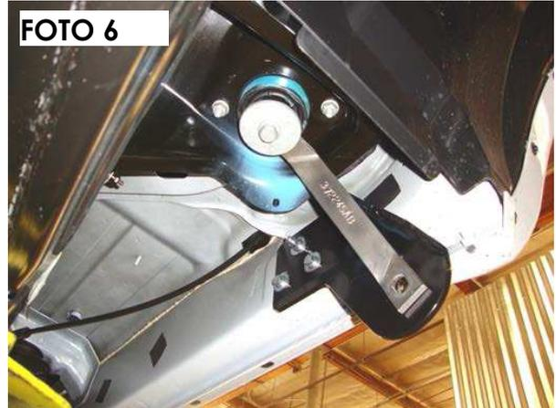
8. Para instalar el bracket auxiliar trasero, localice la rondana y el tornillo de montaje de la cabina trasero. Remuévalos y coloque el bracket auxiliar trasero, reinstale la rondana y el tornillo de montaje. Sujete el otro extremo del bracket auxiliar al bracet trasero y fijelo utilizando un tornillo c/hex 3/8 x 1 1/4", rondana plana, de presión y tuerca hex 3/8" No apriete aún. Foto 7 y 8.
