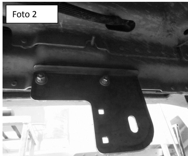
2. Instale el bracket auxiliar utilizando una tuerca M8 galvanizado gris, una rondana plana 5/16" galvanizado gris y una rondana de presión 5/16" galvanizado gris, luego fije el bracket auxiliar al bracket delantero con dos tornillos cabeza coche de 5/16", dos rondanas planas 5/16", dos rondanas de presión 5/16" y dos tuercas 5/16. **(Foto 3)**
