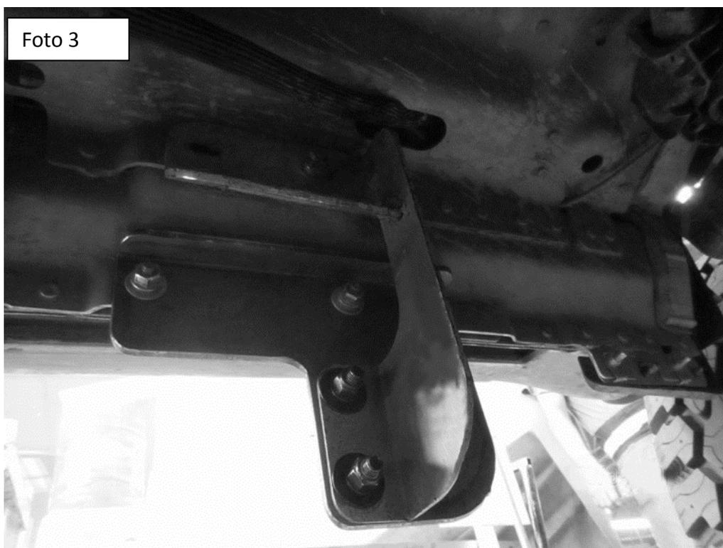
3. Localice los tornillos M8 soldados en la parte inferior central de la camioneta e instale el bracket central, utilice tres tuercas M8 galvanizado gris, tres rondanas planas 5/16" galvanizado gris y tres rondanas de presión 5/16" galvanizado gris. **(Foto 4 y 5)**
