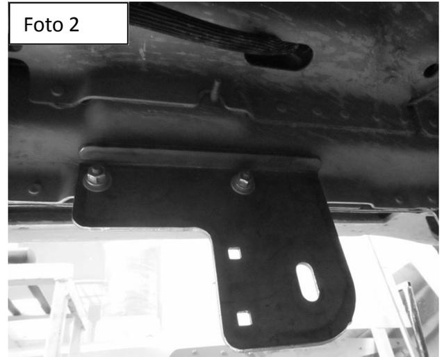
2. Instale el bracket auxiliar utilizando (1) tuerca M8 galvanizado gris, (1) rondana plana 5/16" galvanizado gris y (1) rondana de presión 5/16" galvanizado gris, luego fije el bracket auxiliar al bracket delantero con (2) tornillos cabeza coche de 5/16", (2) rondanas planas 5/16", (2) rondanas de presión 5/16" y dos tuercas 5/16. No apriete aún. (**Foto 3**)
