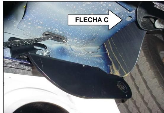
En esta foto se indica el orificio cuadrado en donde se inserta el tornillo 5/16" con solera. Foto lado conductor.
