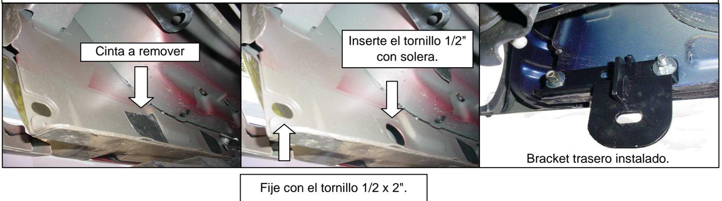
5. Para instalar el Side Bar, monte el Side Bar al bracket delantero y fije con: ( 1 ) tornillo cab. hex. 1/2 x 2", ( 1 ) rondanas plana y de presión 1/2". Asegúrese de fijar al mismo tiempo el bracket auxiliar delantero. No apriete aún. **Ver ilustración 2.**
