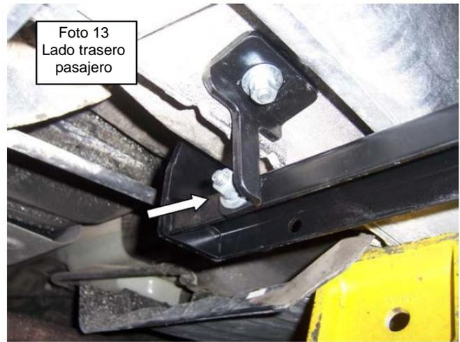
14.- Ajuste el lado del conductor, en la parte superior de los brackets y ajustar el estribo lateral con el vehículo.
