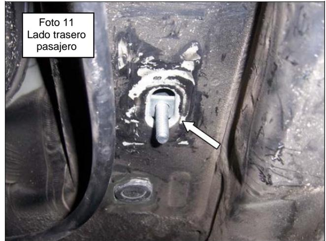
12.- Fije los brackets del lado del pasajero trasero en la parte inferior de la estructura con la solera con tornillo de 3/8" x 1-½", (1) 3/8" Rondana plana, (1) 3/8" Rondana de presión y (1) 3/8" tuerca hexagonal, (Foto # 12). Deje la tuerca hexagonal suelta para el ajuste final.
