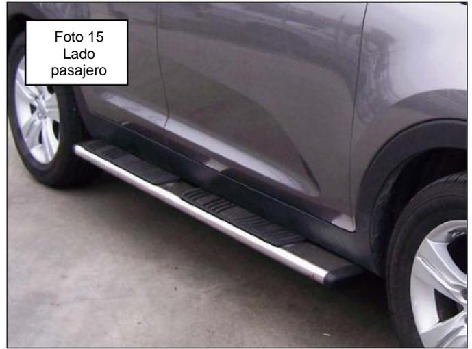
15.-Vuelva a alinear los estribos laterales con el vehículo y apriete, fijaciones, tuercas y los tornillos del vehículo.
