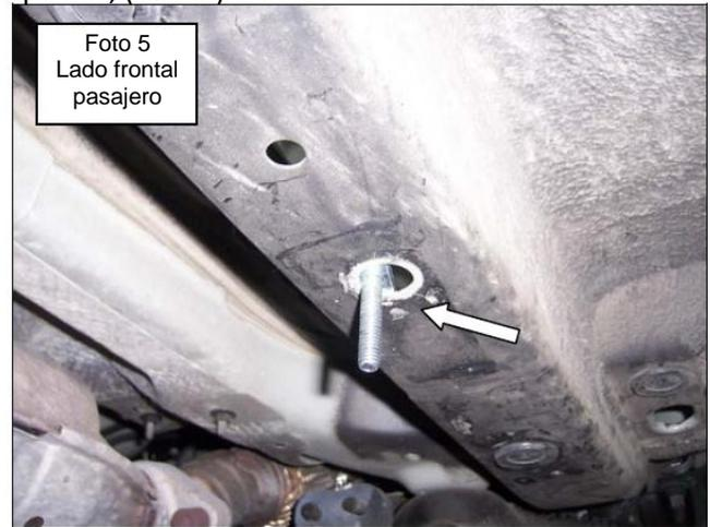
7.- Una el bracket frontal del lado del pasajero a la parte inferior de la estructura con la solera con tornillo 5/16 "x 1 ½", (1) 5/16" Rondana plana, (1) 5/16" Rondana de presión y (1) 5/16" tuerca hexagonal, (foto # 6). Deje la tuerca hexagonal suelto para el ajuste final.
